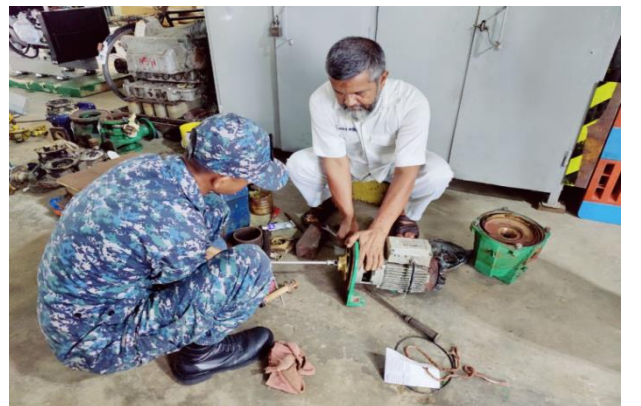
চিত্রঃ বানোঁজা ধলেশ্বরী এর সী ওয়াটার হাইড্রোফোর পাম্প মেরামতের স্থির চিত্র।
