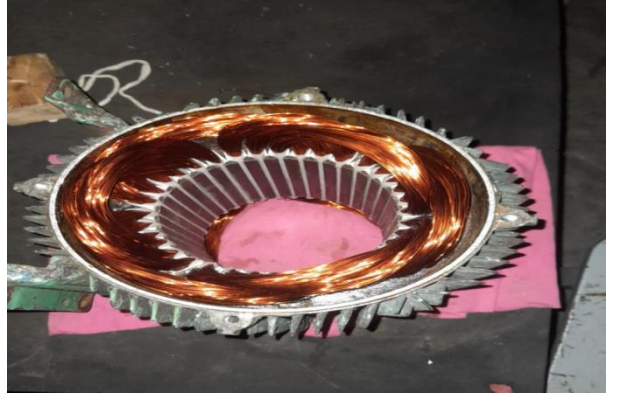
চিত্রঃ বানৌজা তুরাগ এর পশ্চাদ এসি প্লান্ট রোয়ার মোটর (৪৪০ ভোল্ট, ৫.৫ কিলোওয়াট) রি-ওয়াইন্ডিংকরণ এর স্থির চিত্র।
