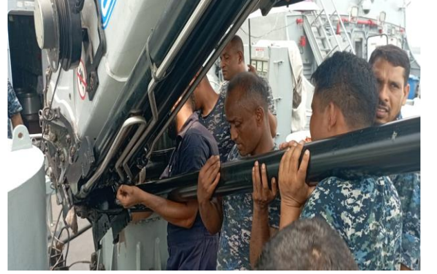
চিত্রঃ বানৌজা দুর্গম এর ডেক ফ্রেন হাইড্রলিক র‍্যাম মেরামতকরণ এর স্থির চিত্র।
