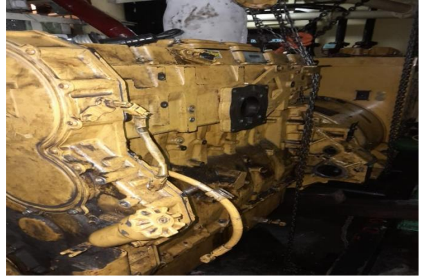
চিত্রঃ বানৌজা বিজয় এর ডিজি নং- ১ মেজর ওভারহলিংকরণ এর স্থির চিত্র।
