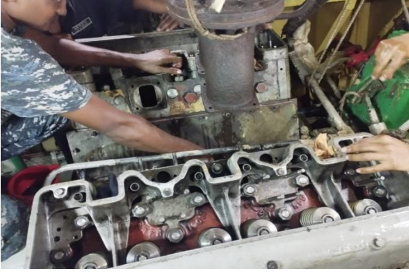
চিত্রঃ বানৌজা করতোয়া এর ডিজি নং- ৩ মেজর ওভারহলিংকরণ এর স্থির চিত্র।
