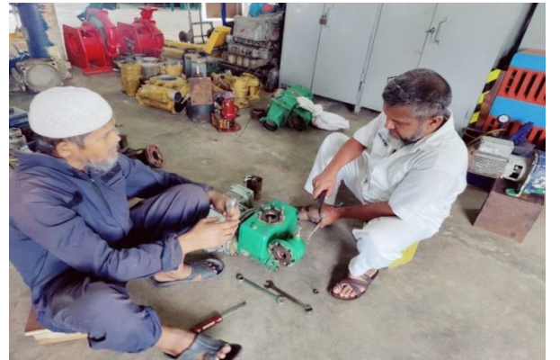
চিত্রঃ বানৌজা ওমর ফারুক এর মেইন ফ্রিজ প্লান্ট কুলিং পাম্প মেরামতকরণ এর স্থির চিত্র।
