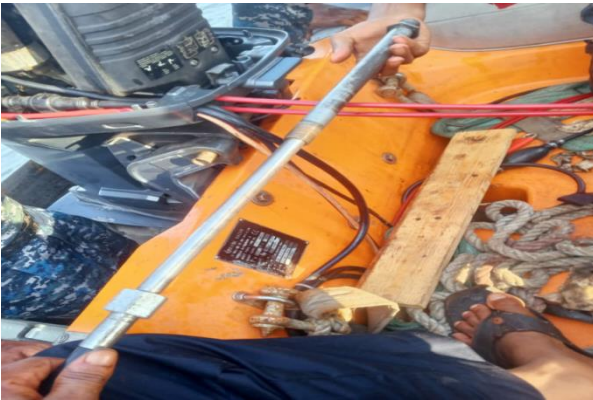
চিত্রঃ বানৌজা অপরাজেয় এর ডান প্রধান ইঞ্জিন সী ওয়াটার পাম্প মেরামতকরণ এর স্থির চিত্র।
