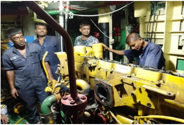
চিত্রঃ বানৌজা ধলেশ্বরী এর ডিজি নং- ১ টপ ওভারহলিংকরণ এর স্থির চিত্র।
