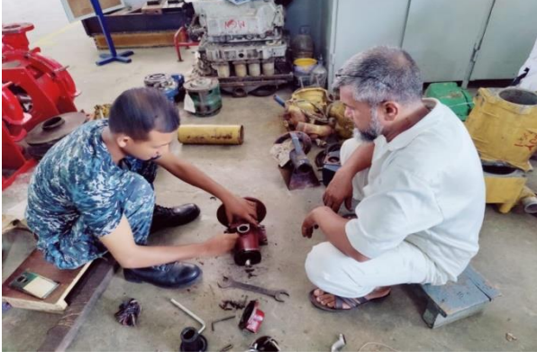
চিত্রঃ বানৌজা ধলেশ্বরী এর ফ্যুয়েল ট্রান্সফার পাম্প মেরামতকরণ এর স্থির চিত্র।
