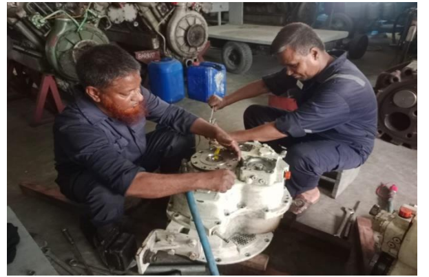
চিত্রঃ বানৌজা মোংলা বোটপুল/ মেটাল শার্ক- ২২ এর গিয়াবক্স মেরামতকরণ এর স্থির চিত্র।
