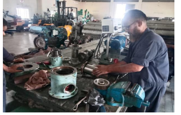
চিত্রঃ বানৌজা আলী হায়দার এর ডিজি নং- ১ এর এয়ার স্টার্টার মোটর মেরামতকরণ এর স্থির চিত্র।
